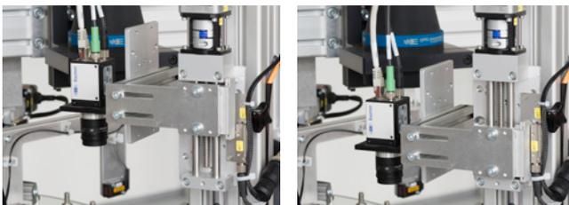
Die Positionen von Kameras und Leuchtkörpern können innerhalb des Verfahrbereichs von 45 mm frei programmiert werden.
