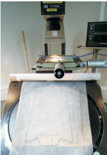
**Museumsreif?** Im Vergleich mit dem Einzel- und Stichproben-Messplatz visiProfil sind Profilprojektoren unterlegen. Das BV-System erübrigt das Aus-richten der Prüflinge, prüft in Sekun-denbruchteilen die gewünschten Krite-rien und speichert die ermittelten Messwerte oder übergibt sie zur Aus-wertung an die SPC oder auch ein ex-ternes CAQ-System.
